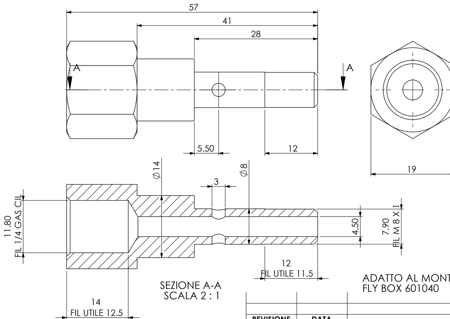
ADATTO AL MONTAGGIO SENSORE MICROEL
