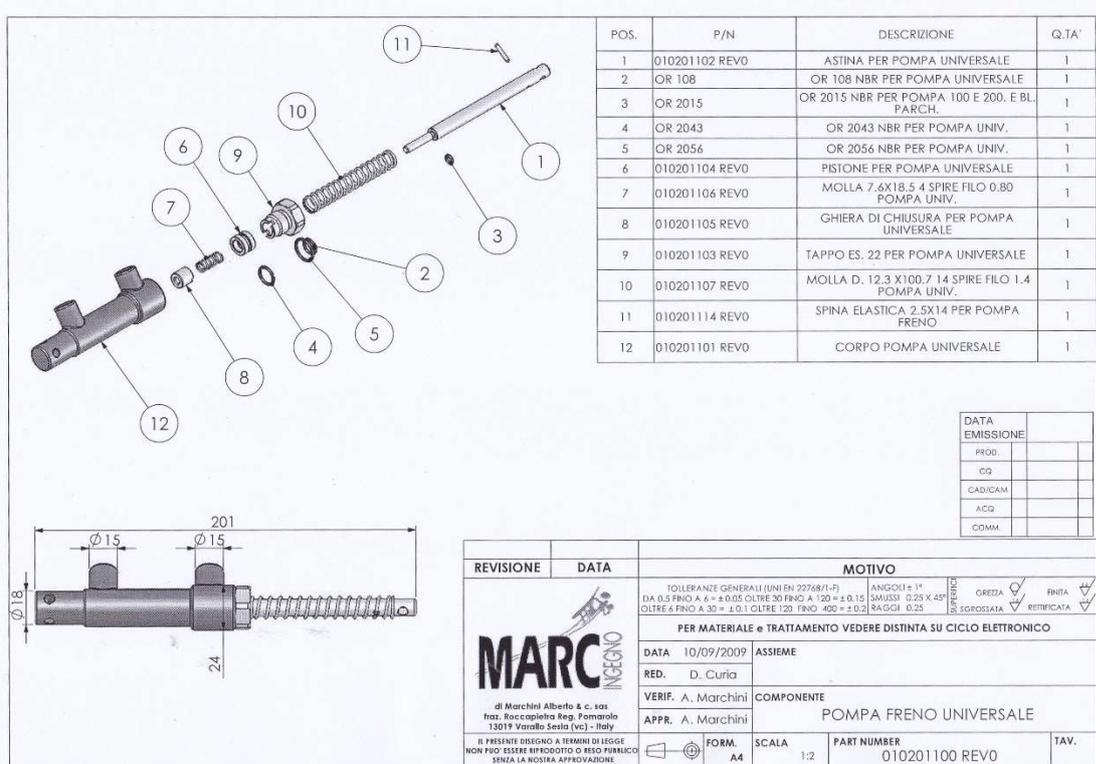
Premessa: il ripristino della pompa è da effettuarsi dopo aver svuotato l'impianto idraulico, tutti gli O-ring devono essere ingrassati.
